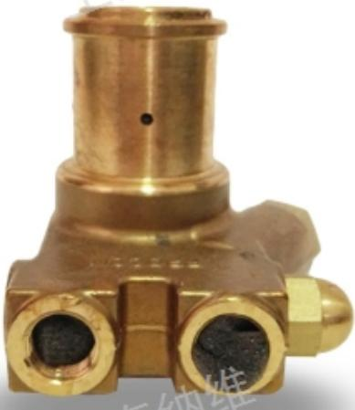
供应咖啡机，饮料机，啤酒输送，水处理设备用PROCON旋转叶片泵。美国PROCON高压进口叶片泵是世界名优产品，属容积泵，流量可从40立升/小时至2000立升/小时范围内选择不同型号，材质由黄铜或不锈钢各自组成不同系列，单级旋转叶片可达扬程140至170米水柱，适用于输送各类清洁、低润滑性能的液体。叶片与泵体无金属接触，不仅经久耐用，而且扭距小，节省能源。该泵具有压头高、噪音低、震动小、无脉冲、可自吸、自润滑、流量恒定、使用数年不用维修等特性。102A100F系列PROCON叶片泵技术参数：材质黄铜，无内置滤网，内置安全阀，流量为125加仑每小时，压力250PSI。自吸型叶片泵，夹具固定、螺栓固定，黄铜叶片泵应用于碳酸水软饮料机、高压咖啡机、啤酒冷却系统、雾化系统、洗车系统、蒸汽清洁机、X射线和医用激光冷却系统、锅炉给水系统等。
